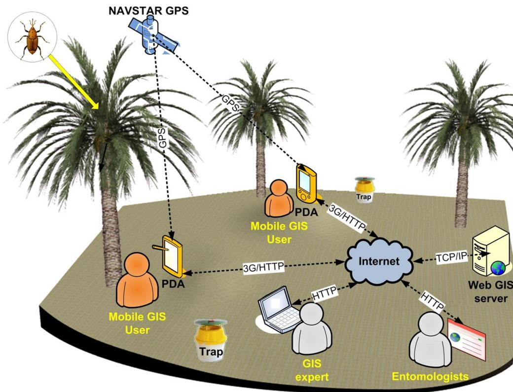
Figure 2. The monitoring system design (Structure du système de surveillance)
